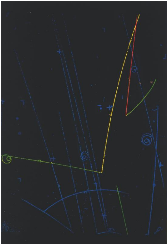
Reakce \pi^- s jádrem v bublinové komoře produkuje K^0 a \Lambda
